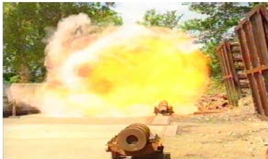
Coup de poussières de farine Essai INERIS
